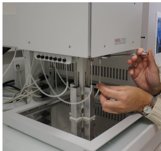
Figure : Collecteur de fractions couplé à une chromatographie en phase gazeuse. Les composés cibles extraits de la matrice des céramiques et sont séparés par chromatographie des contaminants extérieurs puis sont piégés dans les pièges en laine de verre contenus dans les trappes pour être mesurés par la méthode du radiocarbone.
